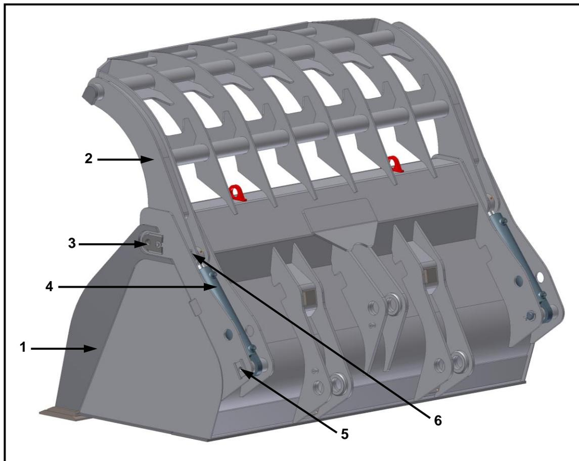
Abb. 2.1: Aufbau Haltebügelschaufel
