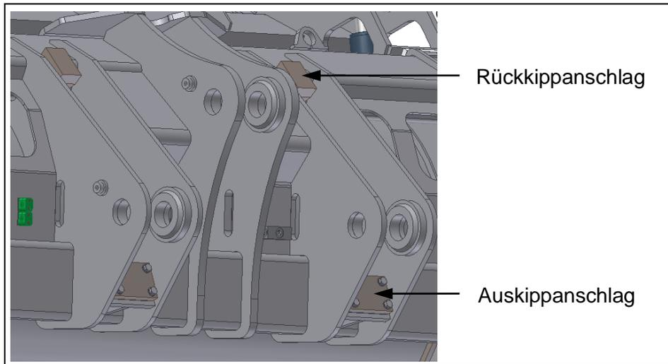
Abb. 5.2: Schaufelanschläge
